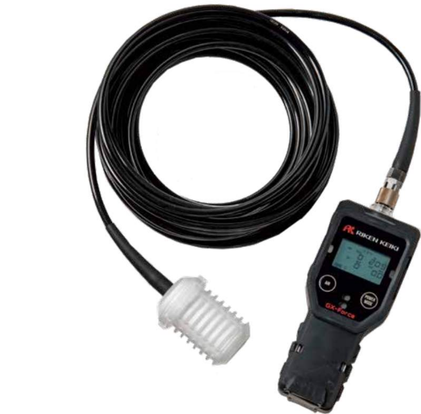
Пробоотборный шланг с поплавком (длина шланга 8 метров)
